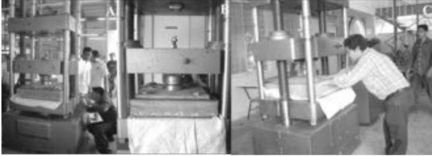
Figura 3.27. Secuencia componente de posicionamiento a ensayar, las imágenes A, B y C, muestran la colocación de la placa de acero de 1 pulgada de espesor para distribuir la carga de compresión
