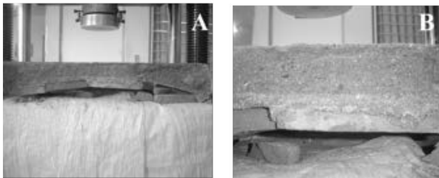
Figura 3.29. Vista del Componente bajo prueba, con las fisuras y la sección de la rotura transversal que pasa por el centro del componente. Fotos A y B muestran la sección rota después de que el último elemento se sometió a carga en el ensayo.
