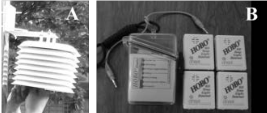
Figura 3:37. Equipo de registro térmico de calor automático familia HOBOT 8. En la foto A, el sensor de registro de la temperatura del aire exterior con escudo contra la radiación solar, en la foto B el sensor para el registro de la temperatura interior.
