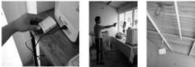
Foto 7.- Izquierda. Descarga datos al programa Hobo Ware Pro.
