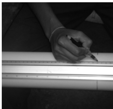
Fig. 1, Definición del tamaño del componente fabricado con tubo de PVC de 3" o 4" de diámetro Fuente: Elaboración de prototipo experimental.
